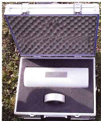
Figur 9: Set für Sondentest: Plastikzylinder, Quelle.
