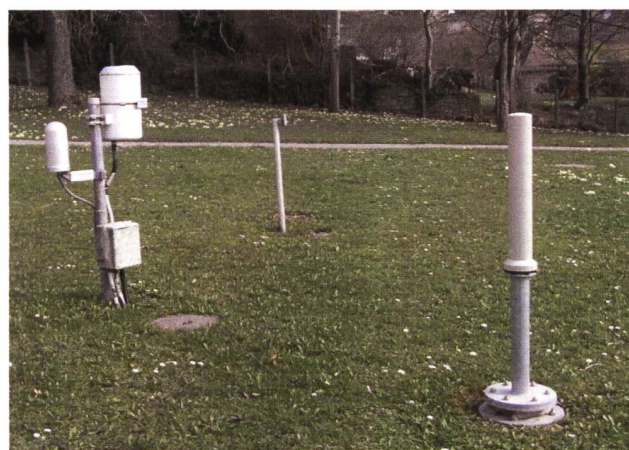
Figur 5: Eine alte und eine neue NADAM-Sonde bei der Station Zürich-Fluntern: Die alte Sonde ist das Messgerät mit der abgerundeten Spitze auf der linken Seite des Mastes. Die neue Sonde steht rechts im Bild.
