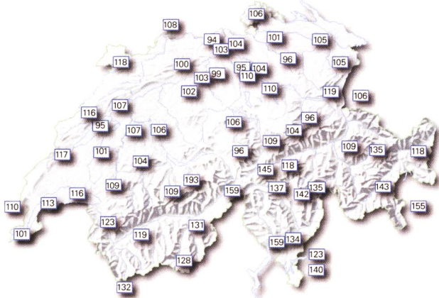
Figur 2: Karte der Jahresmittelwerte 2008 der NADAM-Sonden. Der Jahresmittelwert der Ortsdosisleistung variiert je nach Standort zwischen 94 und 193 nSv/h.
