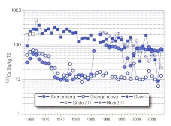
**Figur 4:**<sup>137</sup>Cs in Bodenproben verschiedener Stationen der Schweiz (1964 – 2008)
