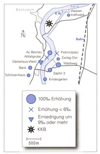
**Figur 10:**Netto Δ¹⁴C-Werte in der Umgebung des Paul Scherrer Instituts (PSI), des Zentralen Zwischenlagers Würenlingen und des Kernkraftwerks Beznau (KKB) im Jahre 2007. (Jost Eikenberg, R. Siegwolf, PSI)
