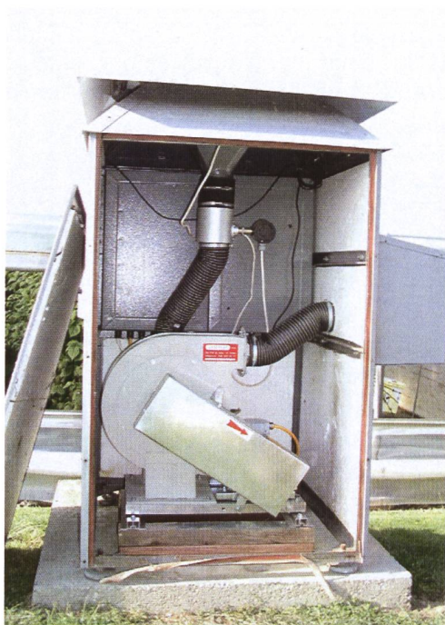
Photo 3: Collecteur d'aérosols à grand débit de Güttingen/TG (500 à 700 m 3 /h; type ASS-550)
