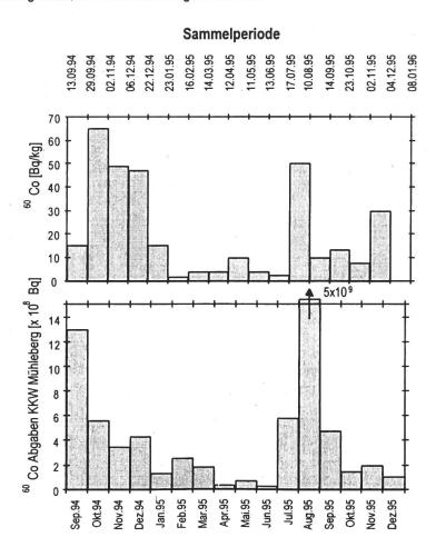
Abbildung 5: oben: Aktivität von <sup>60</sup>Co als Funktion der Zeit in Sedimenten des Stausees Niederried (unterhalb KKW Mühleberg); unten: Monatliche <sup>60</sup>Co-Abgaben des KKW's Mühleberg an die Aare.
