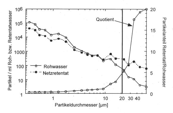
Abbildung 3: Ermittlung der Trenngrenze des benutzten Algennetzes. Neben den Partikelkonzentrationen im Rohwasser und im Retentat ist der Quotient beider in % dargestellt. Erhöhte Quotienten zeigen den Beginn der Partikelabtrennung an, der bei etwa 20 µm einsetzt.
