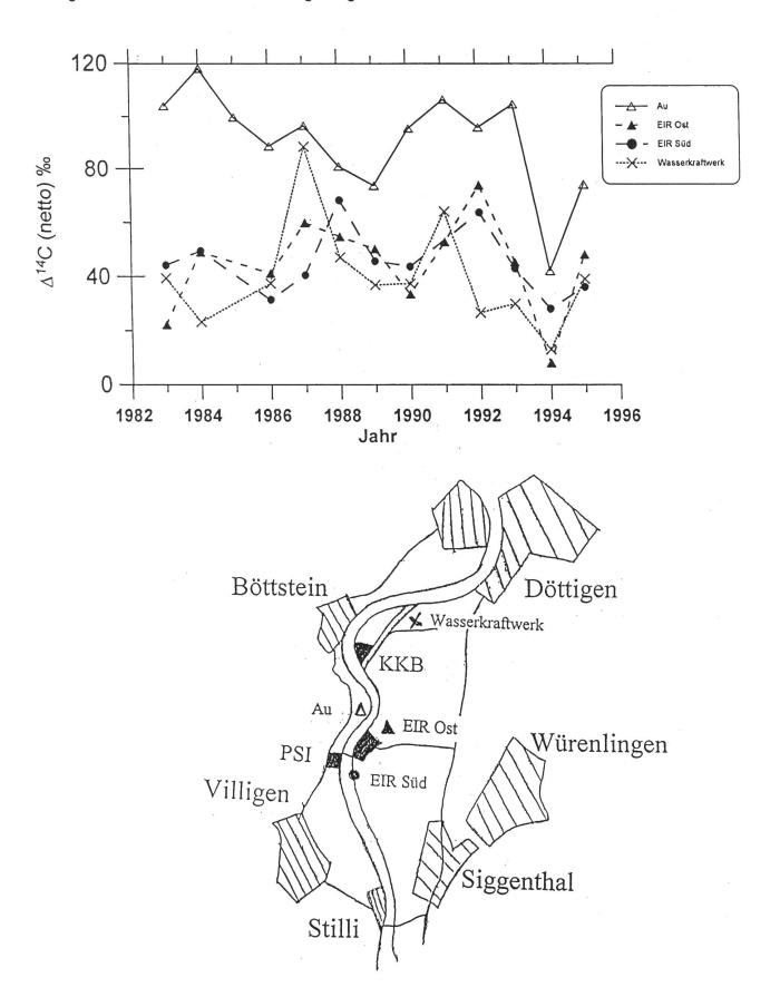
Fig. 3:  $\Delta^{14}$ C in der Umgebung des Reaktors SAPHIR (netto)
