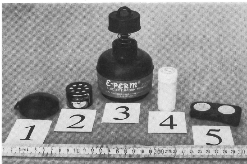
Passive Radon-Dosimeter: 1) Spaltspur-Dosimeter; 2) Spaltspur-Dosimeter; 3) Elektret-Dosimeter; 4) Aktivkohle-Dosimeter für die Flüssigszintillationsmessung; 5) Aktivkohle-Dosimeter für die Personenüberwachung.
