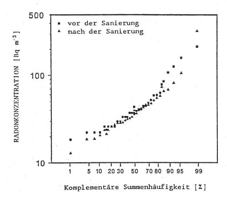
Figur 1. Verteilung der Radonkonzentration in 132 Räumen von Mehrfamilienhäusern vor und nach der Abdichtung der Gebäudehülle. Die logarithmisch-normale Verteilung der Messwerte zeigt keine wesentlichen Einflüsse von Abdichtungsmassnahmen der Gebäudehülle auf den Radonpegel.
