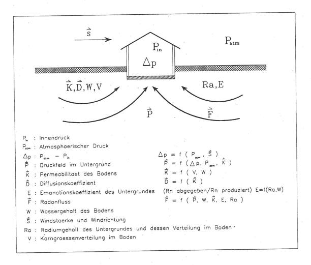
Figur 1: Die wichtigsten Einflussparameter auf die Rn-Innenluft-Konzentration
