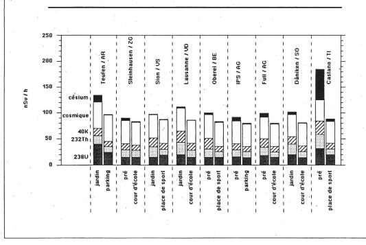
Fig. 3.3.5.b : Contributions à l'exposition externe à l'extérieur et à l'intérieur de bâtiments
