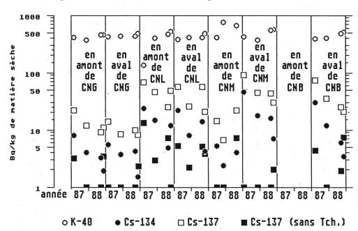
Fig.4.25: Sédiments au voisinage des centrales nucléaires
