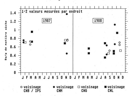
Fig.4.24: Bêta totale dans les eaux de rivières au voisinage des centrales nucléaires
