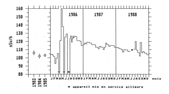
Fig.4.9: Débit d'exposition externe mesuré à l'aide d'une chambre à ionisation NIEDERGÖSGEN (VOISINAGE CNG)
