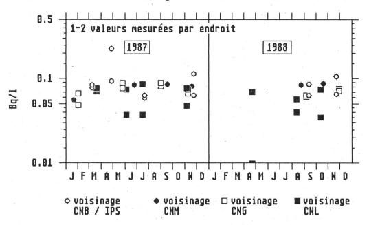
Fig.4.22: Tritium dans dans les nappes phréatiques au voisinage des centrales nucléaires
