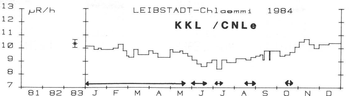
Fig. 4: Ortsdosisleistung und deren Zusammensetzung in der Umgebung der Kernanlagen, berechnet aus den Feldmessungen mit tragbarem Ge(HP)-Detektor, 1984
