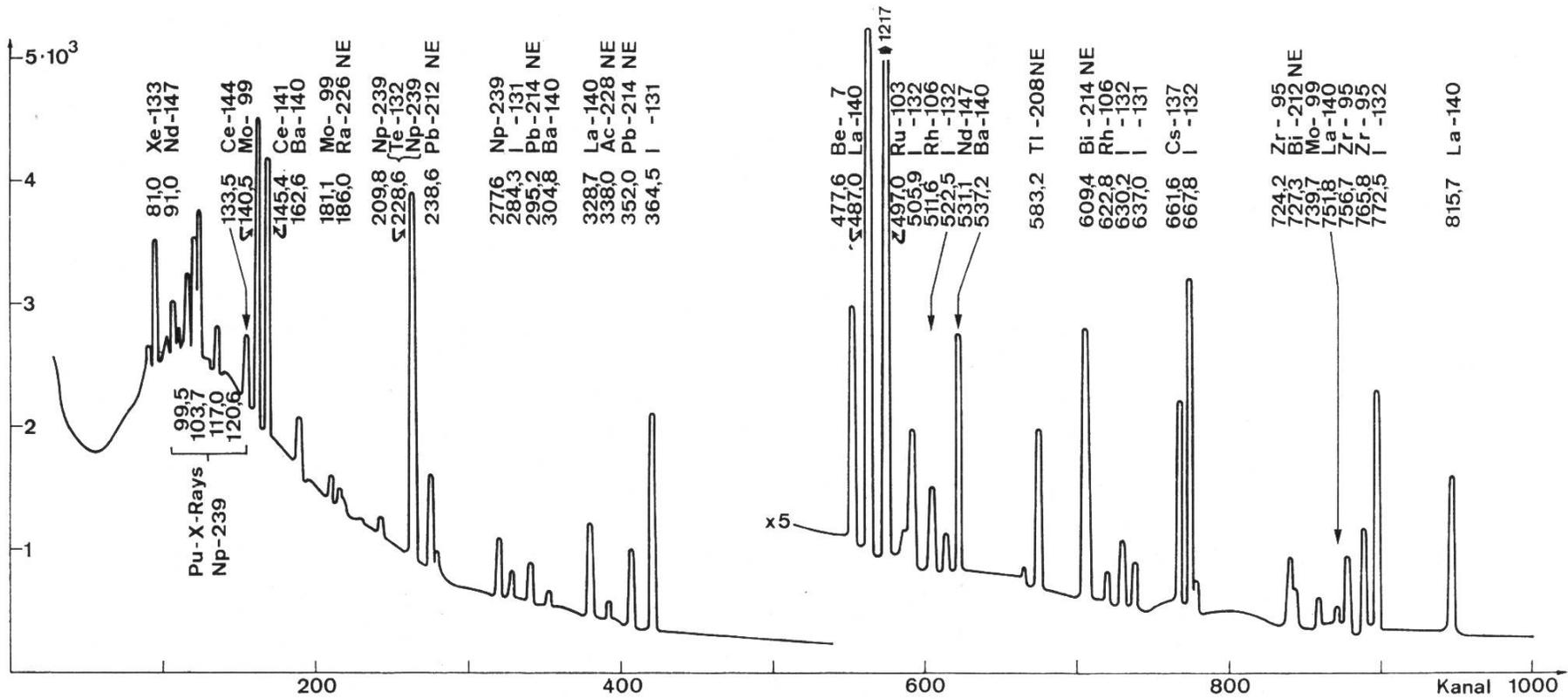
Fig. 5. Gammaspektrum einer Luftprobe aus der oberen Troposphäre, gesammelt am 17.1.1972, gemessen am 19.1.1972
