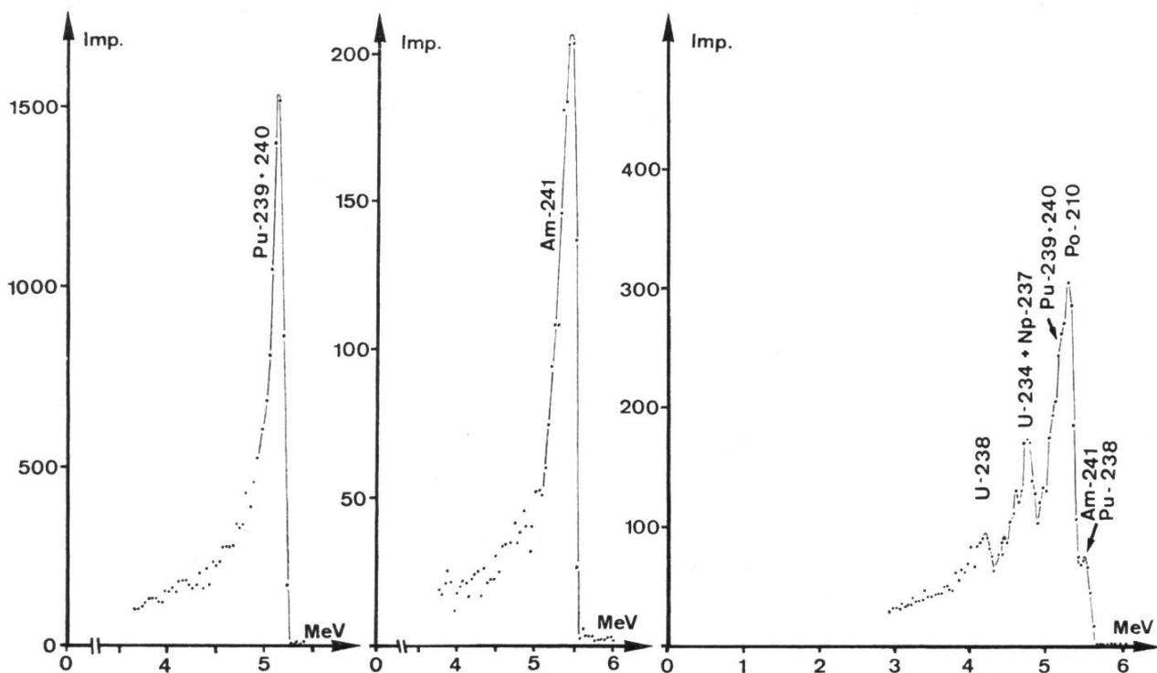
Fig. 2. Alpha-Spektren mit Gitterionisationskammer,
