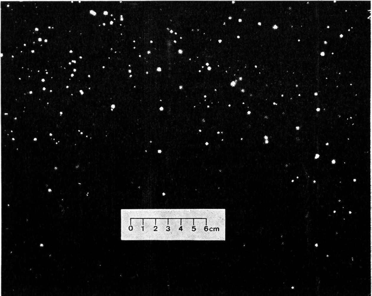
Fig. 6. Autoradiographie eines Luftfilters (10 700 m Höhe) mit heissen Teilchen, gesammelt am 28.3.1972
