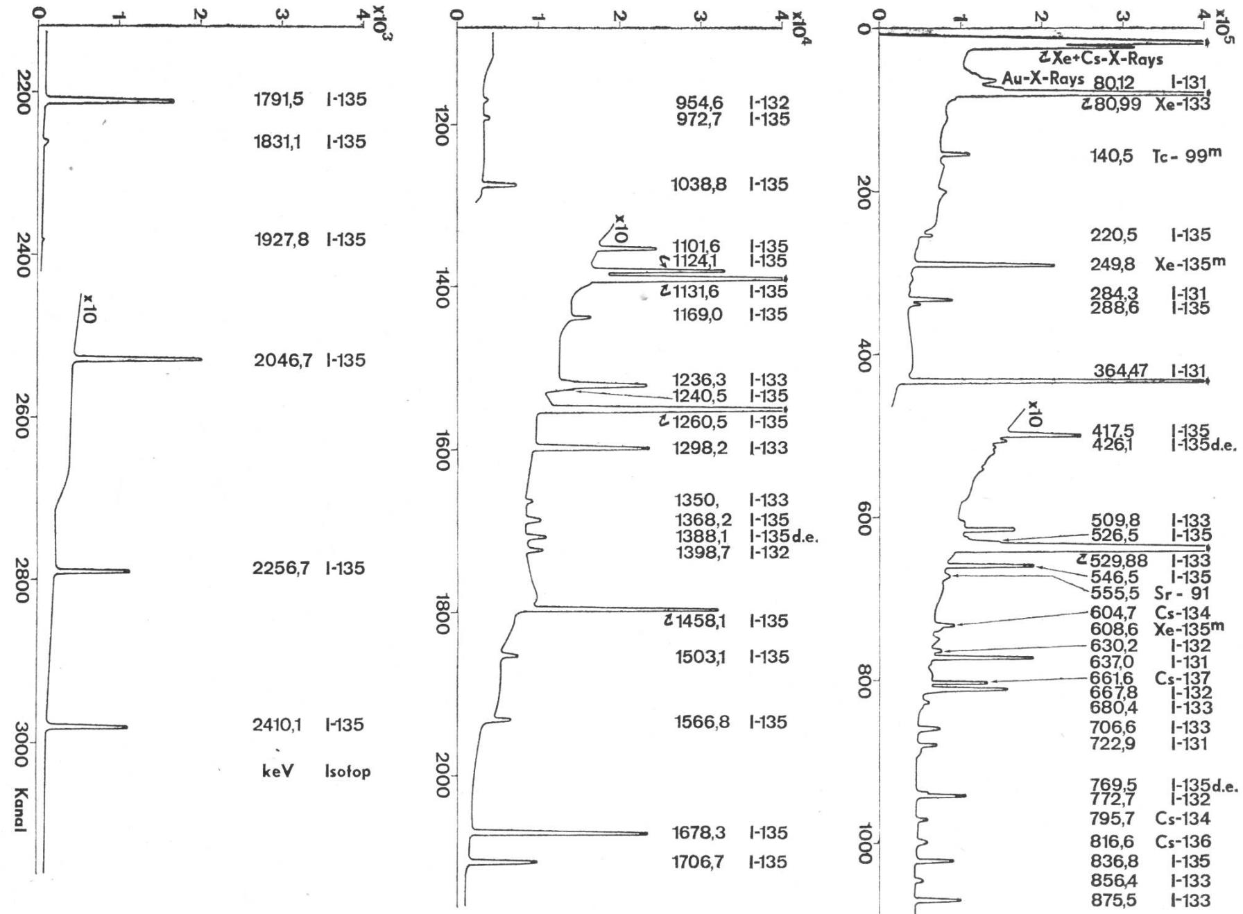
Fig. 11. Gammaspektrum einer entgasten Wasserprobe aus dem Primärkreislauf des Atomkraftwerks Beznau, entnommen 23. 4. 70, gemessen 6 Stunden später mit einer Ge-(Li)-Planardiode
