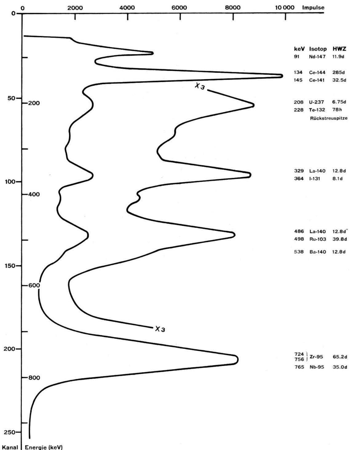
Fig. 3. Gammaspektrum einer Probe A der chinesischen Atombombenexplosion vom 24.12.67, gemessen am 25.1.68 mit einem Na-I-Bohrloch-Kristall von  $4,5 \times 5$  Zoll
