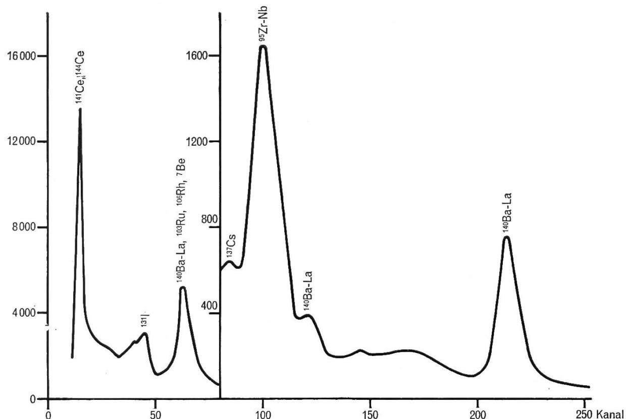
Fig. 7. b) Gammaspektrum eines Luftfilters aus 8500 m Höhe (obere Troposphäre), gesammelt 18.11.66, gemessen 23.11.66.
