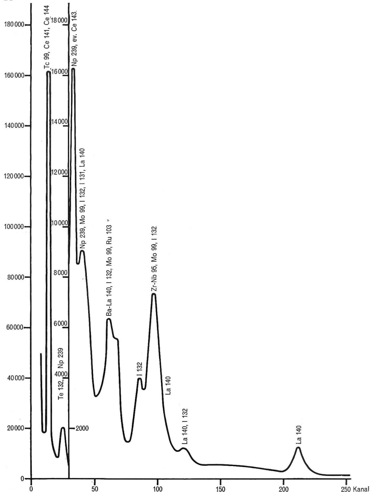
Fig. 6. c) Gammaspektrum einer Probe aus Südamerika, gesammelt am 23.7.66, gemessen am 26.6.66 mit einem 3×3-Zoll-NaI-Kristall.
