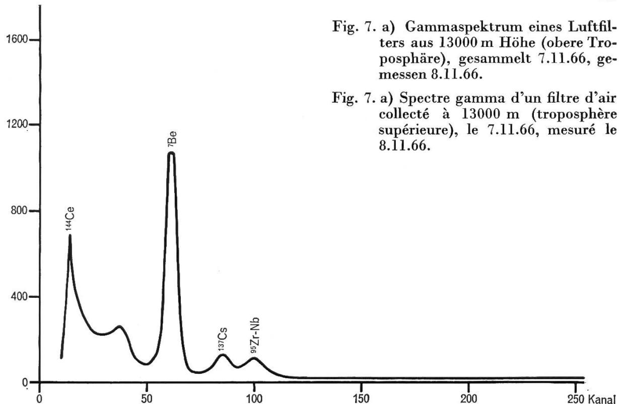
Fig. 7. a) Gammaspektrum eines Luftfilters aus 13000 m Höhe (obere Troposphäre), gesammelt 7.11.66, gemessen 8.11.66.
