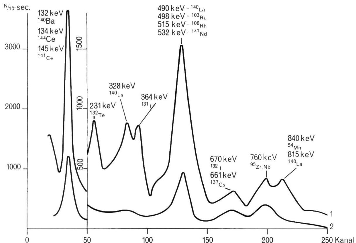
Fig. 3b. Gamma-Spektrum des Luftstreifens vom Jungfraujoch vom 26. 10. 64, gemessen am 6. 11. 1964 (Kurve 1) und am 22. 12. 64 (Kurve 2). Das Auftreten junger, kurzlebiger Fissionsprodukte röhrt von der chinesischen Bombe vom 16. 10. 1964 her.
