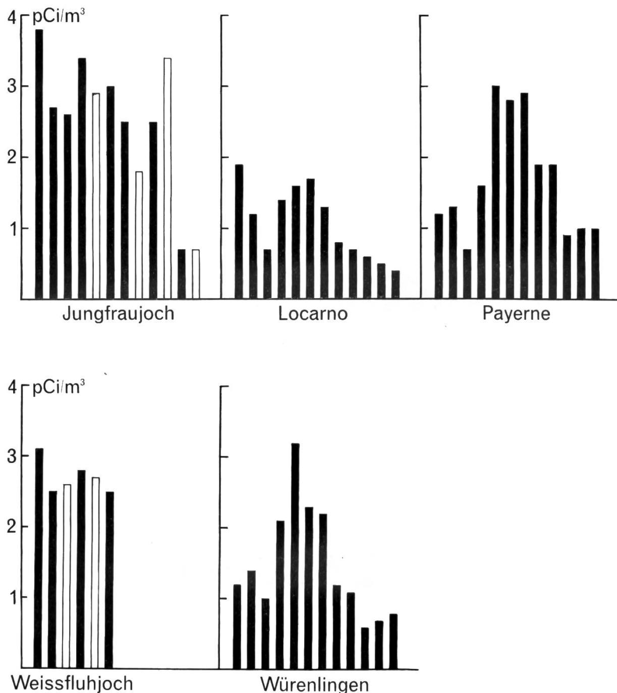
**Fig. 1.** Monatliche Mittelwerte der spezifischen Gesamt-Betaaktivität der Luft, bezogen auf 760 mm Hg und 0° C, für die Messstellen Jungfraujoch, Locarno, Payerne, Weissfluhjoch und Würenlingen.
