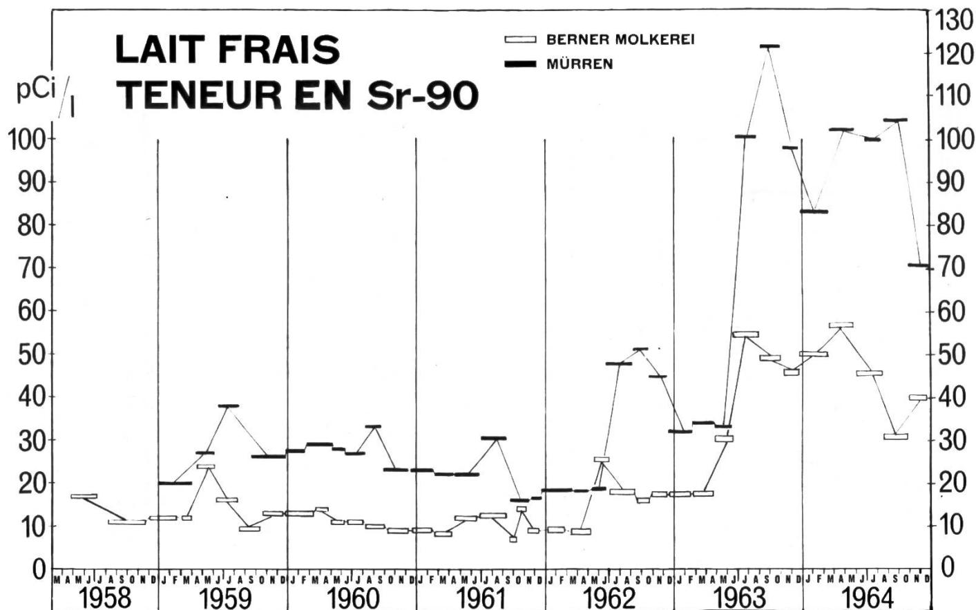
Fig. 8. Spezifische Strontium-90-Aktivität von Frischmilch aus dem Flachland (Bern 540 m) und aus einer Höhenlage (Mürren 1650 m).
