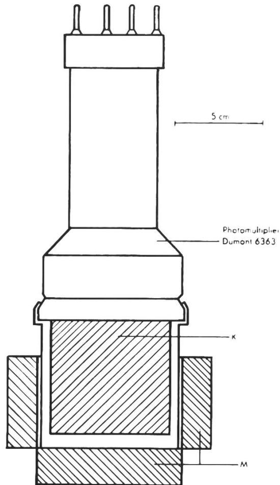
Fig. 1. Messanordnung für Milchpulverproben
