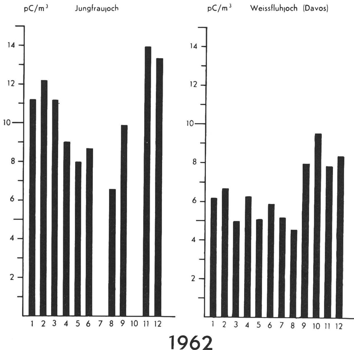
Fig. 3. Monatliche Mittelwerte der spezifischen Gesamt- $\beta$ -Aktivität der Luft, bezogen auf 760 mm Hg und 0° C, für die Messstellen Jungfraujoch, Weissfluhjoch, Locarno, Payerne und Würenlingen während der Zeit vom 1. Januar bis 31. Dezember 1962.
