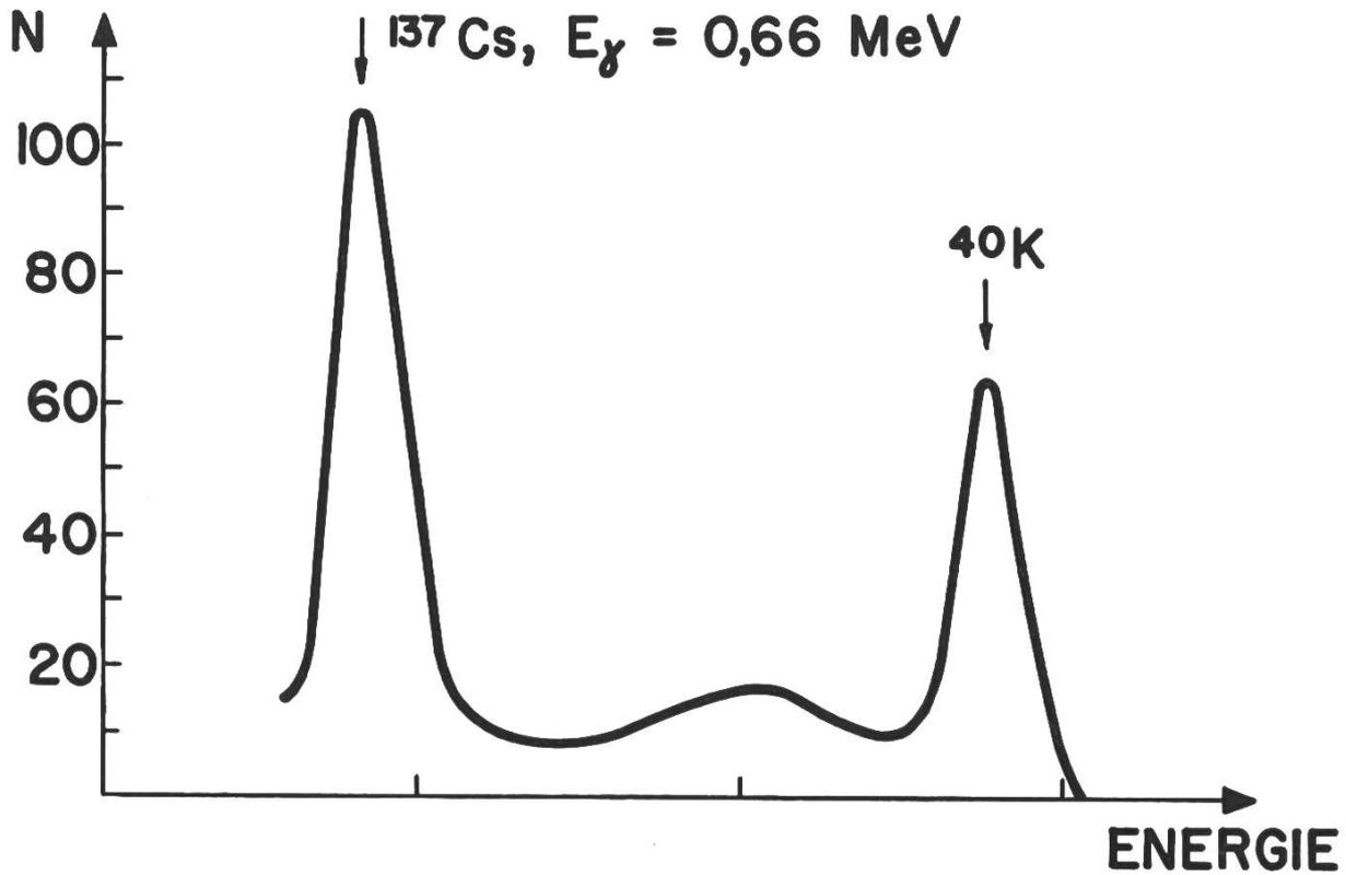
Fig. 23a. Gamma-Spektrum einer Trockenmilchprobe vom Juni 1962.
