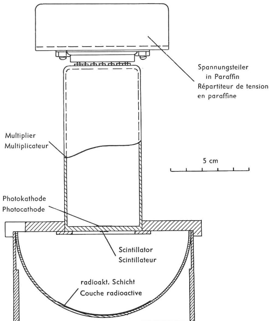
Fig. 3. Anordnung zur Messung des Alpha-Energiespektrums von radioaktiv verseuchten Proben
