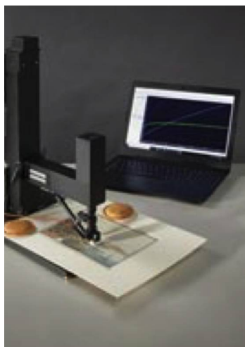
Micro Fading Testing permet de déterminer la durée d'exposition d'un objet.
