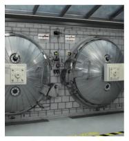
L'installation papersave swiss à Wimmis. Les deux chambres sont fermées: l'installation est en ser-
