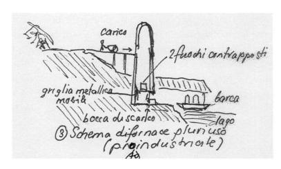
Questa tipologia consisteva in una costruzione fissa a torre, con le pareti isolate all'interno, in modo che non si distruggesse dopo la cottura. Per talune fornaci si adoperava il carbone come combustibile, disposto a strati alternati al calcare.
