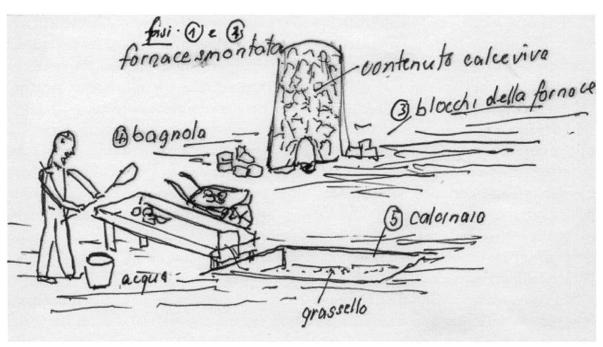
Schema delle fasi di produzione della calce
