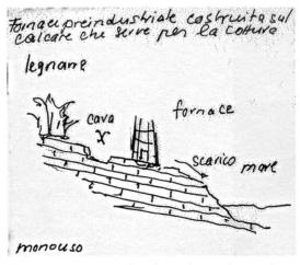
Fornace monouso, che viene ricostruita ogni volta. Esempi in Istria.
