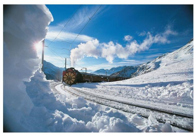
Sgombraneve a turbina "Xrot d 9213" (a vapore, del 1910) sul Passo del Bernina
