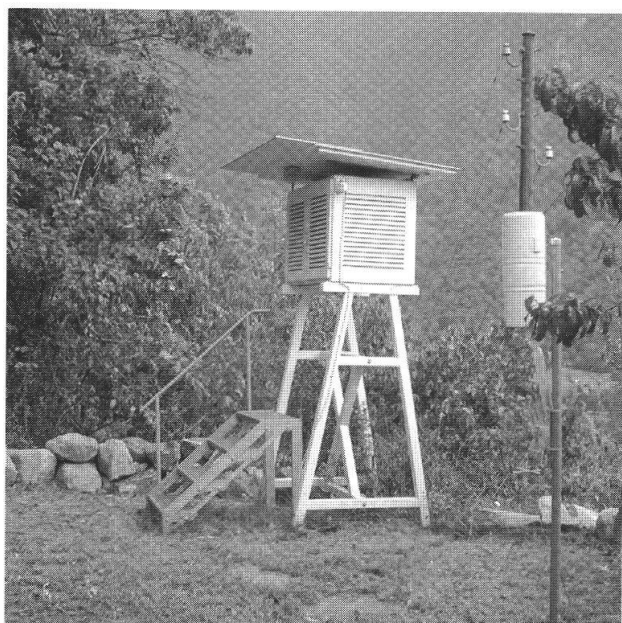
Capannina meteorologica e pluviometro della stazione di Grono.
