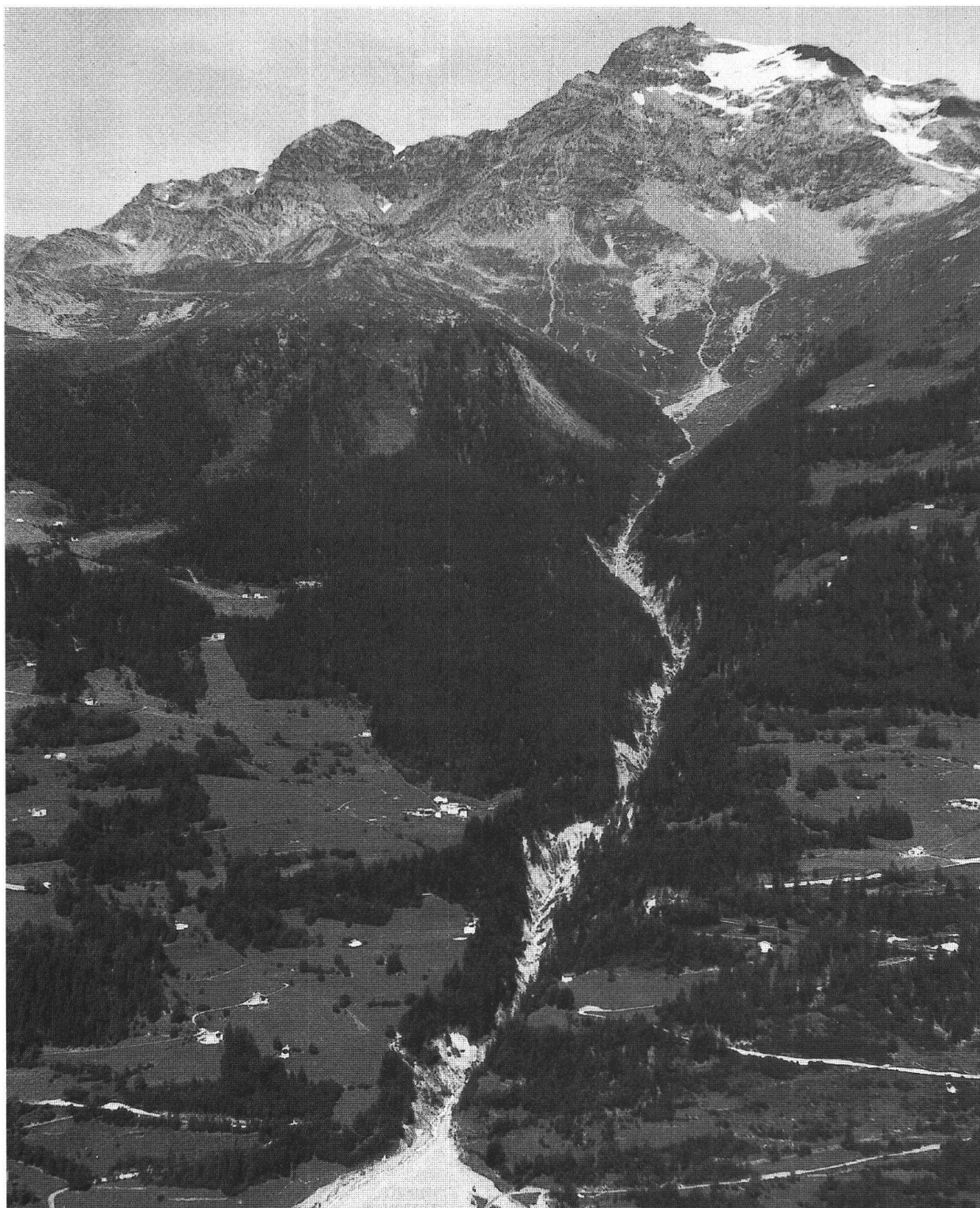
La Val Varuna dopo le mure del luglio 1987. Sotto le rocce del Piz Varuna si riconosce una superficie innevata fino a tarda estate. Qui si trova la zona dove hanno avuto origine le diverse mure. La Val Varuna venne erosa a partire da 2700 metri fino all'inizio del cono di deiezione a 1180 metri e lungo certi tratti fino ad una profondità di 10 metri. La maggior parte del materiale rimosso venne depositato sul cono (foto A. Godenzi, Coira).
