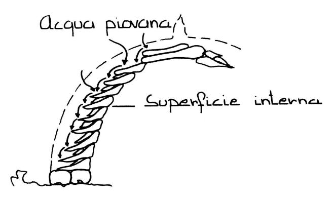
Per non permettere all'acqua piovana di penetrare all'interno si adottava un si-
