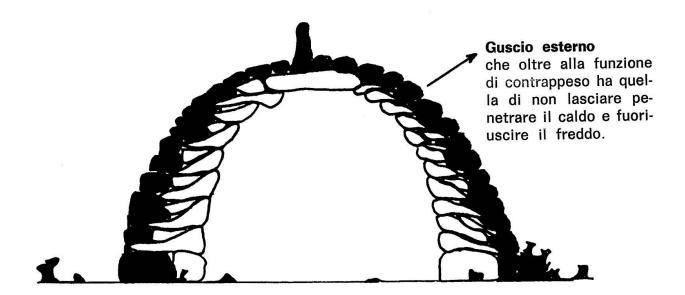
Questo guscio aveva la funzione di contrappeso al fine di rinforzare la stabilità e di non permettere ai massi di cadere all'interno della costruzione. Il profilo esterno risultava così un cumulo ordinato di pietre. La costruzione veniva eseguita senza alcun bisogno di armatura provvisoria e senza l'impiego di malta. Ci ricorda la tecnica di costruzione eschimese dell'igloo. Il muro è di forte spessore:
