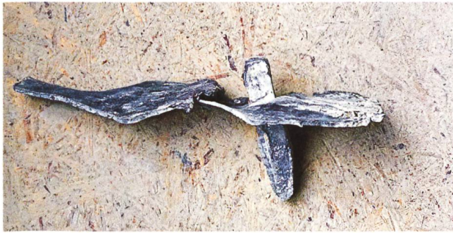
Abb. 30: Bleifuge mit Dübel aus dem Gewölbe der Marktkirche Unser Lieben Frauen in Halle/Saale (1529–1554).
