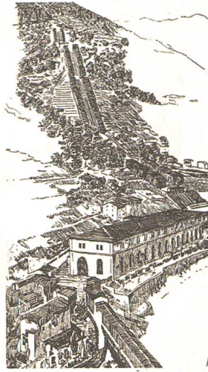
Abb. 20. Gegenvorschlag. Durch Pflanzung von zwei Baumreihen beidseitig der Druckleitung kann der Eindruck einer mächtigen Allee erweckt werden. Zu beachten der Verbesserungsvorschlag für das flache Dach des Maschinenhauses. — Fig. 20. Projet de correction: En plantant des deux côtés de la conduite hydraulique deux rangées d'arbres, on peut donner l'illusion d'une grande allée. Remarquer aussi la correction proposée du toit de la halle aux machines.
