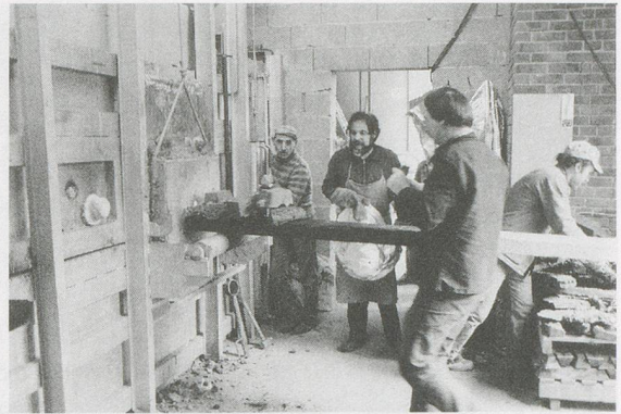
Shortly before pouring, the bronze is melted in the furnace / Kurz vor dem Guss, die Bronze wird im Schmelzofen verflüssigt. (PHOTO: JEAN DUBOS, FONDERIE DE COUBERTIN, 1992)
