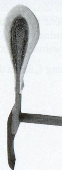
Illustration Kat. 42. Marteau b2, pianoforte Ignace Pleyel & C ie , N° 9166, Paris 1840
