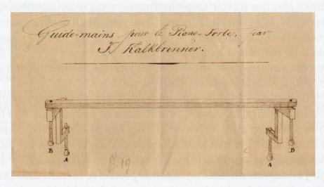
Figure 3. Frédéric Kalkbrenner, *Guide-mains*, brevet d'invention et de perfectionnement de cinq ans, 1<sup>er</sup> août 1831, Paris, INPI, cote 1BA3749, p. 6.
