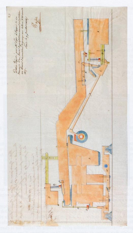
Figure 7. Touche courbe, marteaux en dessous (Jean Henri Pape, 4ème brevet de perfectionnement et d'addition au brevet du 23 août 1837, 23 octobre 1838, Paris, INPI, cote 1BA6100, p. 33).
