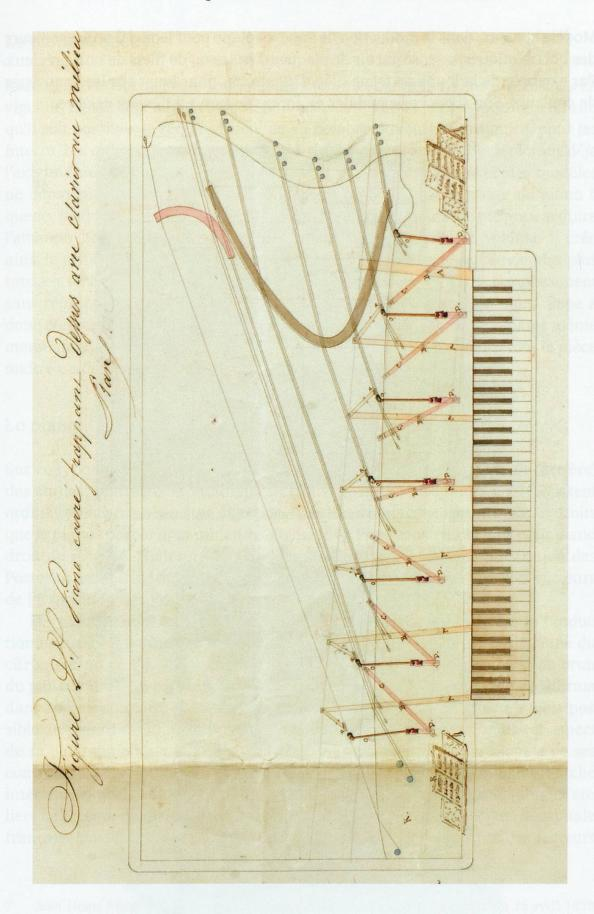
Figure 2. Piano carré à clavier central (Jean Henri Pape, 3<sup>ème</sup> brevet de perfectionnement et d'addition au brevet du 16 avril 1828, 5 août 1833, Paris, INPI, cote 1BA3022, p. 8).
