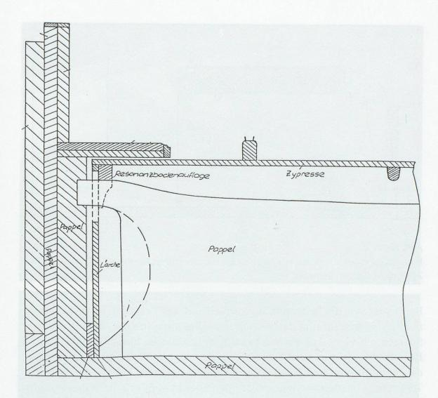
Abb. 5 Konstruktion der doppelten Hohlwand, Hammerflügel Bartolomeo Cristofori 1726, Zeichnung Ute Singer
