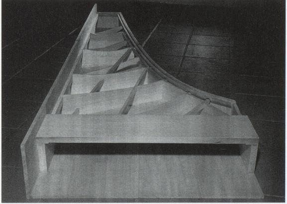
Abb. 7 Stimmstockkonstruktion mit Dammspreizen, Nachbau des Hammerflügels Bartolomeo Cristofori 1726 (Kerstin Schwarz) Abb. 8
