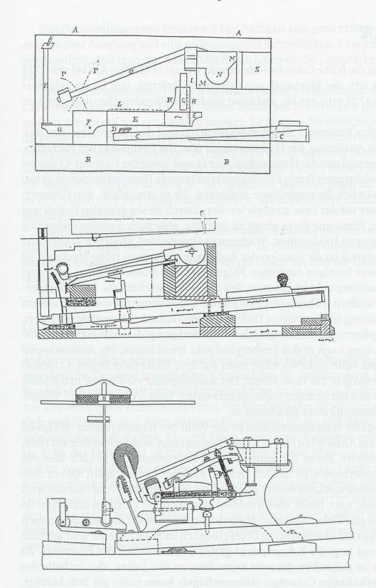
Abb. 2 Gegenüberstellung von früher und später Cristofori-Mechanik sowie einer modernen Flügelmechanik
