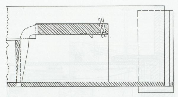
Abb. 6 Konstruktion des invertierten Stimmstocks, Hammerflügel Bartolomeo Cristofori 1726, Zeichnung Kerstin Schwarz
