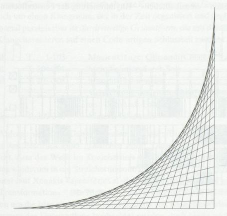
Fig. 4: Zweidimensionale Darstellung einer Regelfläche (hyperbolisches Paraboloid)
