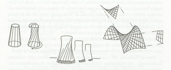
Fig. 29: Regelflächen: Drehhyperboloid, hyperbolisches Paraboloid, Konoid
