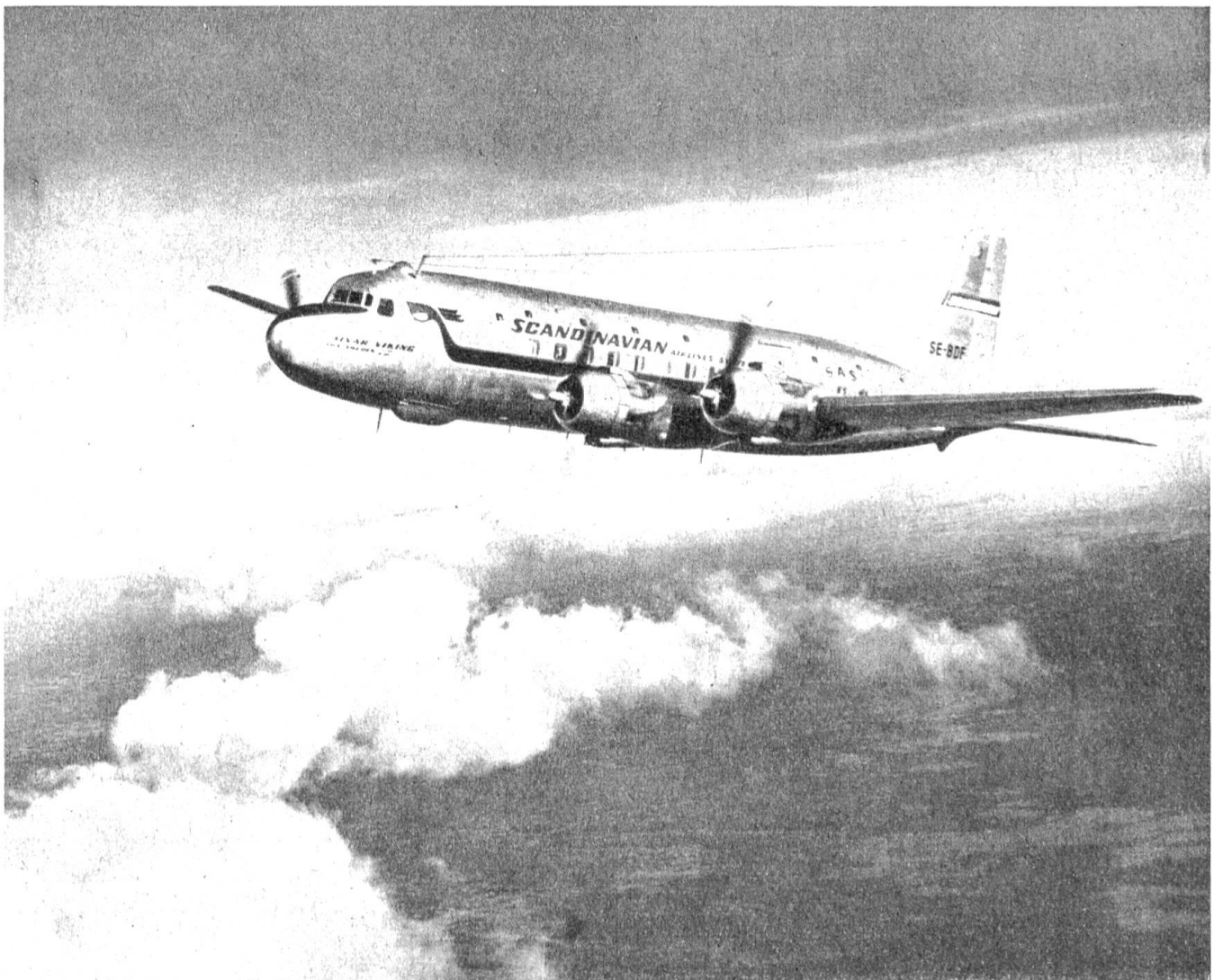
Abb. 1. Flug über den Wolken in 6000 m, der sogenannte „Schönwetterflug“, da meistens die Schlechtwetter mehr in den tieferen Höhen ziehen. Diese Douglas DC-6 ist mit einer Druckluftkabine ausgestattet, so daß ein Flug in 6000 m dem Passagier keine Unannehmlichkeiten bereitet. Die Luft im Passagierraum ist jener in 200 m Seehöhe entsprechend
