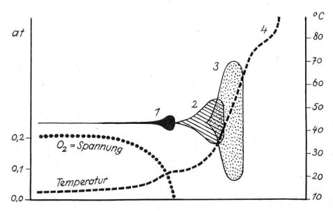
Abb. 1. Schematische Darstellung der Vorgänge bei der Selbstentzündung feuchten Heus. Aerobe Bakterien und Schimmelpilze (1), anaerobe Bakterien (2) und thermophile Anaerobe (3) lösen einander ab. Nachdem auch die hitzeresistentesten Bakterien ihre Lebenstätigkeit eingestellt haben (bei zirka 70°C), steigt die Temperatur durch chemische Vorgänge weiter an (4) und kann schließlich zur Entflammung führen
