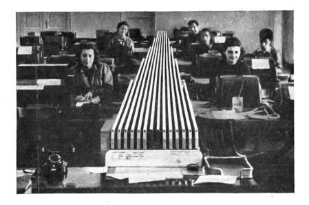
Abb. 5. Dreizehnzeilige Hochkantbandanlage in einem Telegraphenamt
