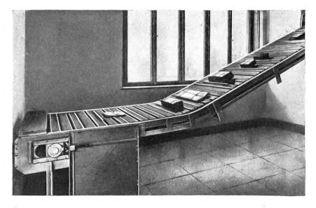
wendige Untersetzung der Umdrehzahl bewirkt. Als Fördermittel werden zumeist Gummigurten verwendet, deren erforderliche Spannung zur Mitnahme des Fördergutes von einer eigenen Spannvorrichtung erteilt wird. Die Tragelemente für den Gurt sind zwei- oder mehrteilige Muldenrollen für den oberen belasteten und gerade Tragrollen für den unteren leer zurücklaufenden Gurtteil.
