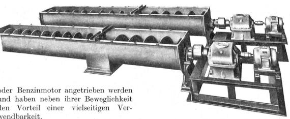
Abb. 7. Förderschnecken in Blechtrögen mit Antriebsstationen
