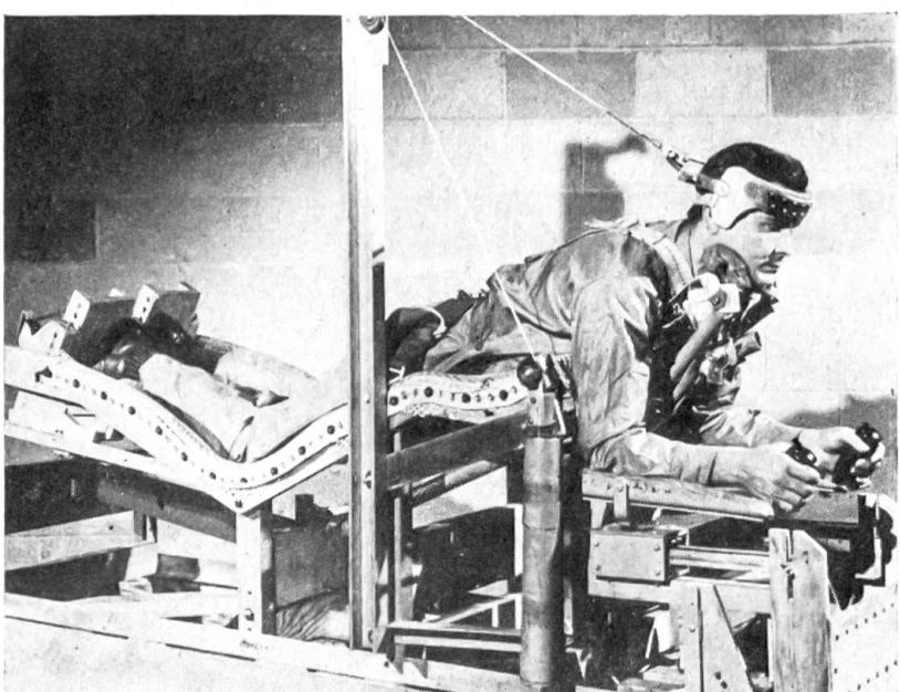
Im Raketenflugzeug wirken besonders beim Abfangen eines Sturzfluges ungeheure Beschleunigungskräfte auf den Piloten ein. Deshalb hat man zunächst auf einem besonderen Versuchsstand die geeignete Sitz- oder besser Liegeposition des Piloten herauszufinden versucht
