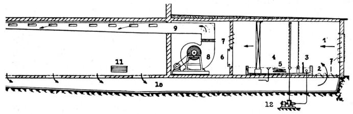
Abb. 3. Schematische Darstellung einer Zentral-Klimaanlage
