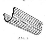
des neuen, aus glasklarem Kunststoff gefertigten Blendschutzes bloß 4°/0, indes die früher verwendeten Blechraster ein Vielfaches an Licht verschluckten. Überdies sind die Kunststoffabschirmungen leichter anzubringen, haben ein geringeres Gewicht, sind
