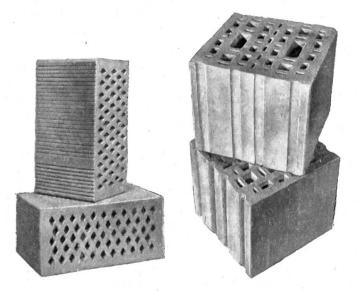
Links: Abb. 3. Gitterziegel (2 Normalziegel). — Rechts: Abb. 4. Groβformatiger Hohlziegel (6 Normalziegel)
