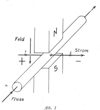
die Ursache hierfür darin zu suchen sein, daß die Industrie erst seit einigen Jahren Verwendungsmöglichkeiten für ein derartiges Gerät geschaffen hat. Bei dem neuen Gerät handelt es sich um eine in den Laboratorien der General Electric konstruierte Pumpe für flüssige Metalle.
