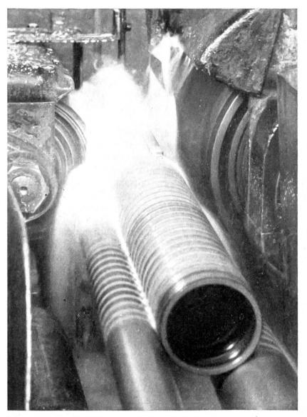
Die Laufringe werden aus Rohren, Stangen oder Schmiederingen hergestellt, und zwar werden sie auf Automaten gedreht, dann gehärtet und schließlich auf Schleifmaschinen bis auf Tausendstelmillimeter genau bearbeitet. Das Bild zeigt das Außenschleifen auf Centerless-Maschinen
