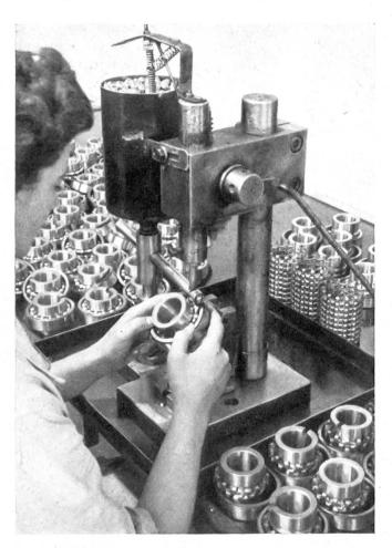
Einfüllen der Kugeln in Pendelkugellager
