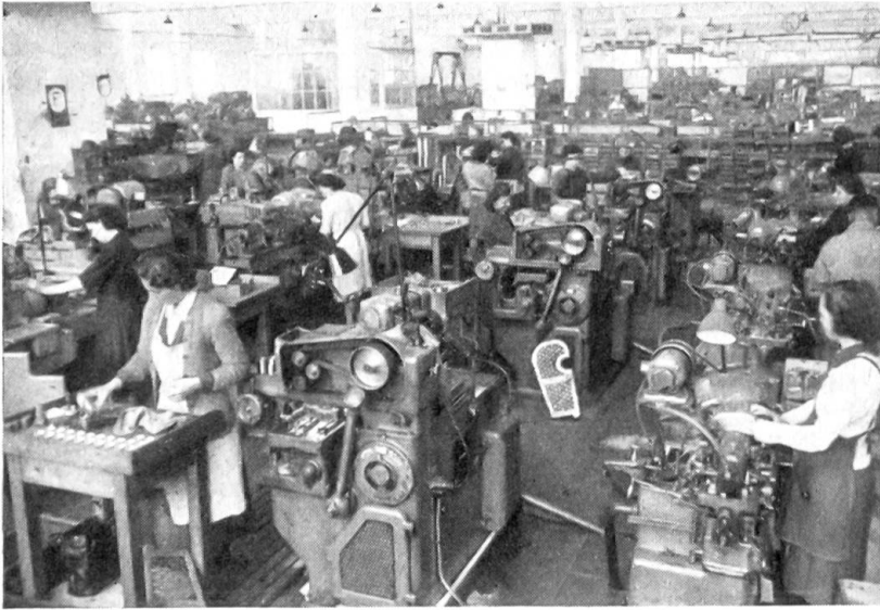
Hier werden die Bohrungen der Innenringe geschliffen
