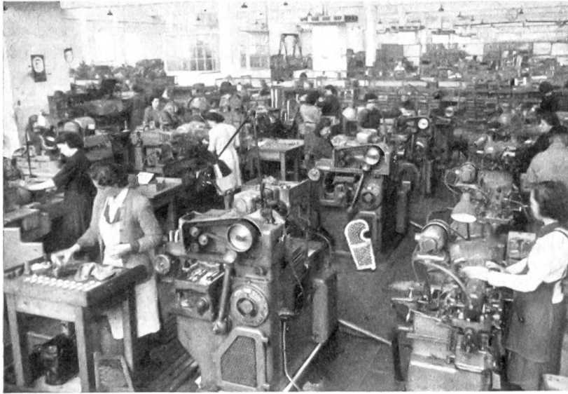
Hier werden die Bohrungen der Innenringe geschliffen
