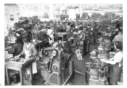
Hier werden die Bohrungen der Innenringe geschliffen (Werkphotos der Steyr-Daimler-Puch A.G., Steyr)
