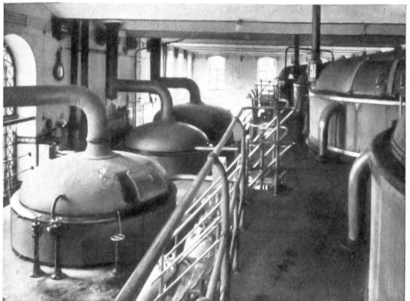
Abb. 3. Blick in ein Sudhaus. Rechts Maisch- und Läuterbottich, links Maisch- und Sudpfanne
