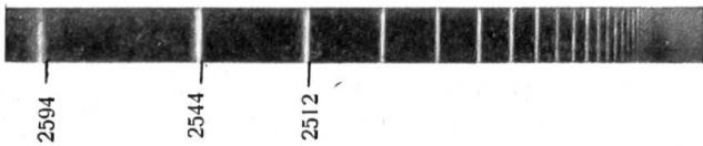
Abb. 7. Absorptionsspektrum des Natriumatoms nach Kuhn. Hier ist nur der kurzwellige Teil von der 5. Linie der Hauptserie an wiedergegeben. Die Linien erscheinen, wie auf der photographischen Platte, als helle Linien
