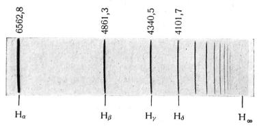
Abb. 2. Das Spektrum des Wasserstoffatoms im sichtbaren und nahen ultravioletten Spektralgebiet (Balmer-Serie) in Emission.
