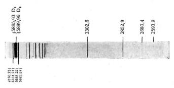
Abb. 8. Emissionsspektrum des Na-Atoms (Lichtbogen mit einer Na-Elektrode). Es sind deutlich drei Serien zu erkennen, von denen die eine, die Hauptserie, mit der Absorptionsserie zusammenfällt
