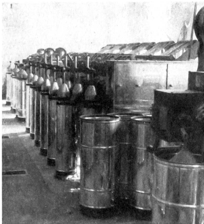
Abb. 2. Eine „Gillstrecke“ zum Verziehen und Verfeinern der Faserbänder
