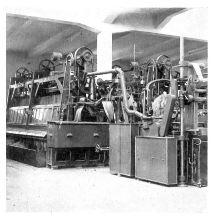
Abb. 1. Hechelmaschine zur Gewinnung des Faserbandes
