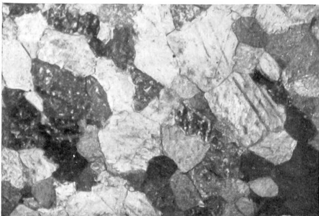
Abb. 6. Kalzitkörner aus einem feinkörnigen Marmor. Man beachte die Zwillingslamellen in einigen der Kalzitkörner. Die einzelnen Kalzitkristalle zeigen allerdings fremde Kristalltracht, da die Umkristallisation zum kristallinen Schiefer eingesetzt hat. (Vergrößerung 100fach, pol. Licht)
