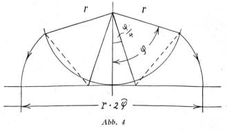
rechnungsmäßig um 0,15% zu groß. Der Fehler ist also größer als bei der Konstruktion nach Abb. 2, aber für gewerbliche Zwecke noch erträglich. In didaktischer Hinsicht ist die letzte Konstruktion zweifellos am vorteilhaftesten, da sie auch auf kleinere Zentriwinkel als 180° (Abb. 4) unmittelbar anwendbar ist, wobei die Genauigkeit jedoch erheblich steigt.
