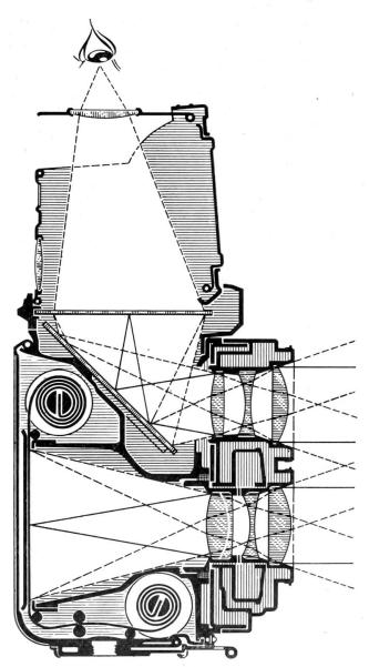
Strahlengang in der Spiegelreflexkamera ("Rolleiflex" und "Rolleicord")
