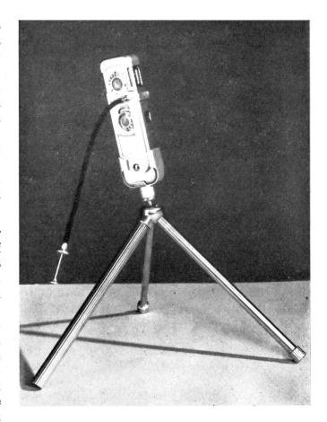
Schärfezeichnung mit einer Lichtstärke von 1:3,5 und einer Brennweite von 15 mm. Die kurze Brennweite ergibt eine derartige Tiefenschärfe, daß ohne Vorsatzlinsen alle Entfernungen von 20 cm bis Unendlich beherrscht werden können. Der Stahl-Lamellen-Verschluß erlaubt Belichtungszeiten von ½ Sekunde, außerdem beliebig lange Zeitaufnahmen. Zwei eingebaute Filter (grün und orange) können durch einen Fingerdruck wahlweise vor das Objektiv geschoben werden.
