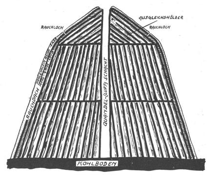
Abb. 5. So sieht der Aufbau eines "Rundmeilers" aus
