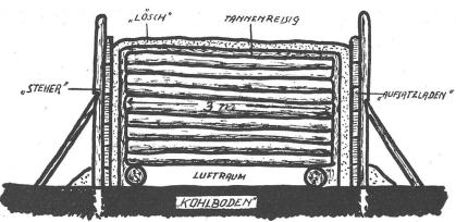
Abb. 4. Querschnitt durch einen "Kohlhauten"
