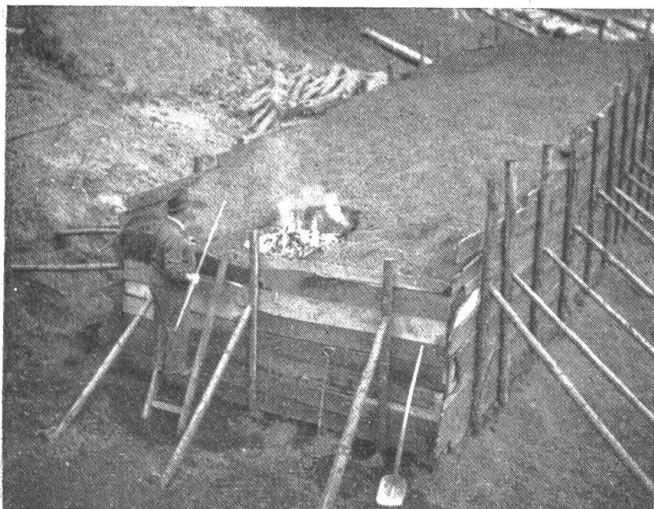
Abb. 3. Nachdem der Haufen „schwarzgemacht“ worden ist, wird er angezündet. Nach einigen Stunden wird die Öffnung mit Reisig und Löss sorgfältig abgedichtet; die Verkohlung beginnt. Deutlich sind die Luftlöcher zu sehen (unten)
