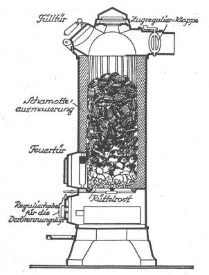
Abb. 2. Schema eines irischen Ofens
