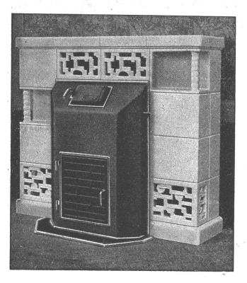
brandeinsatz vereinigt die Vorzüge des Kachelofens, die in der langanhaltenden Wärme liegen, mit denen des Eisenofens, die durch die rasche Wärmeabgabe gegeben sind. Genau so wie bei den Eisenofensystemen lassen sich die Kachelöfen mit Dauerbrandeinsatz genau regulieren, so daß die Raumtemperatur bestimmt werden kann, und der Arbeitsaufwand beschränkt sich bloß auf die Betätigung des Rüttelrostes, das Nachfüllen des Heizmaterials und die Entleerung des Aschenkastens.
